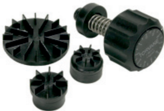
Figura 5. Escisómetro tipo Torvane para la medida in situ del esfuerzo cortante del suelo.
